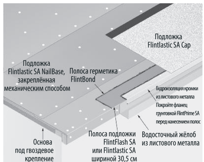
Рис. 5-30. Конструктивные особенности водосточного жёлоба в двухслойной системе.
