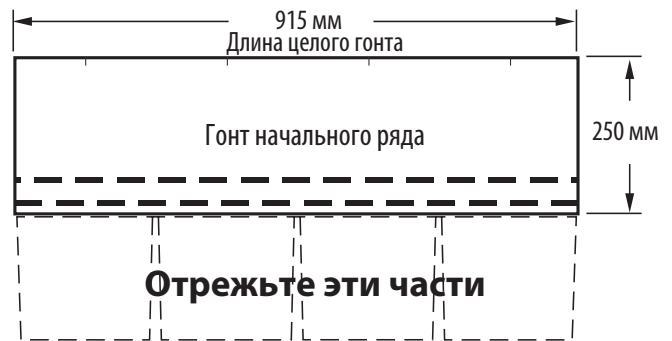
Рис. 14-5. Изготовьте гонты начального ряда, отрезав 20,3 см язычки.
