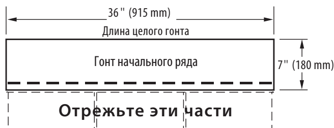
Рис. 10-6. Изготовьте гонты начального ряда, отрезав язычки.
