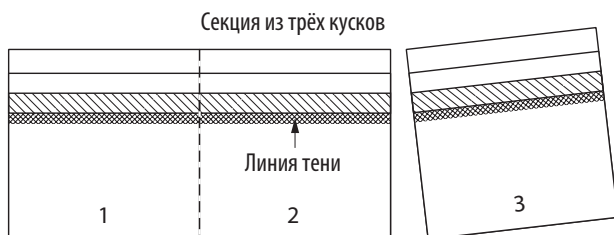
Рис. 12-18. Разделите, чтобы получить 3 покрывающих гонта.
