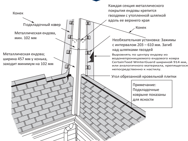
Рис. 6-20: Типичная закрепленная кляммерами открытая ендова
