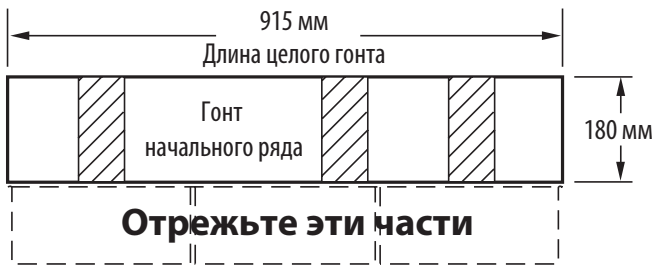
Рис. 13-8. Изготовьте гонты начального ряда, отрезав 5-дюймовые язычки.
