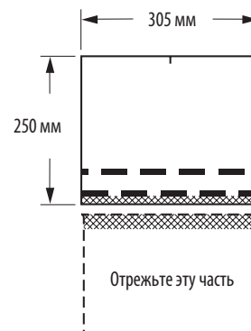
Рис. 14-15. Вспомогательный гонт начального ряда Hatteras.
