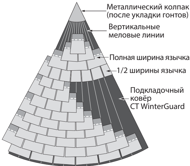
Рис. 9-6. Укладка гонта на округлённую часть крыши.
