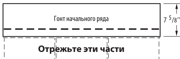
Рис. 12-6. Высота гонтов должна составлять не менее 194 мм.
