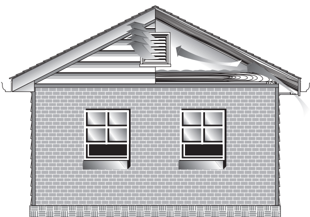
Рис. 7-17. Фронтонное жалюзийное отверстие для выхода воздуха, позволяет лишнему воздуху выходить из чердачного помещения. Отверстия располагаются по краям чердака.
