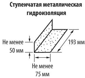
Рис. 12-10. Минимальные размеры ступенчато гидроизоляции.
