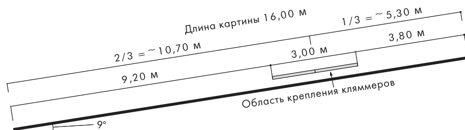
Схема 2.1: Пример односкатной кровли с уклоном 9°, длина картины 16 м
