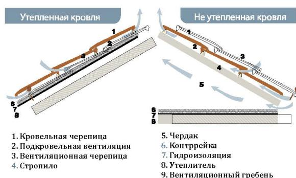
Отверстия на карнизах и коньках должны позволять вентилировать воздух в подкровельном пространстве.
