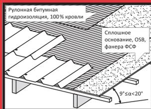
От  $9^\circ$  (15%) до  $20^\circ$  (36%) «Ондувилла» должна укладываться на сплошную обрешетку из ОСП или фанеры ФСФ.
